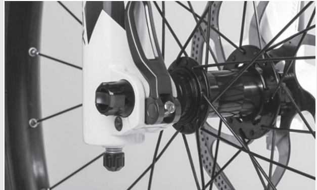
Abbildung 87: Spannkraft des Schnellspanners einstellen
