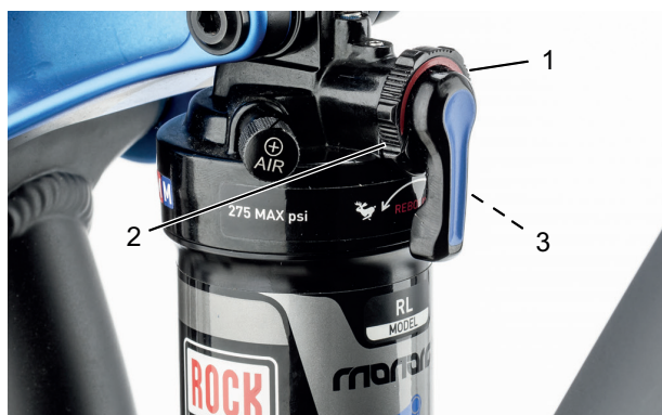
Abbildung 82: Härte des Zugstufen-Dämpfers am Einstellrad (1) des Hinterbau-Dämpfer einstellen
